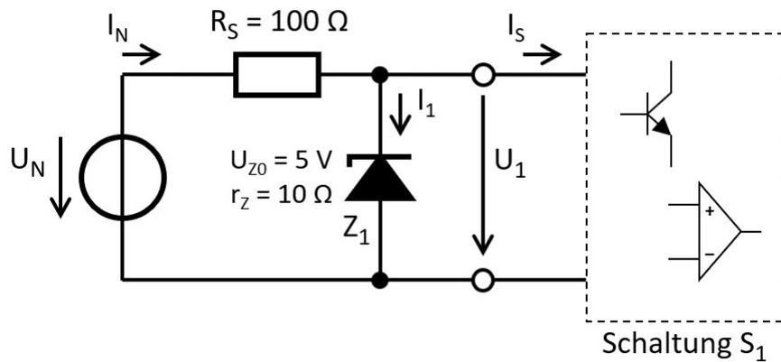
**Zunächst ist die Stromaufnahme der Schaltung S<sub>1</sub> sehr gering (I<sub>S</sub> = 0 mA).**
