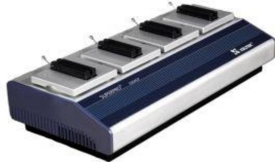
Zur Produktion von mittleren Stückzahlen werden „Production Programmer“ (auch: „Gang Programmer“) eingesetzt, die mehrere Bausteine gleichzeitig beschreiben können, siehe rechte Abbildung (XELTEC SuperPro6104GP).
