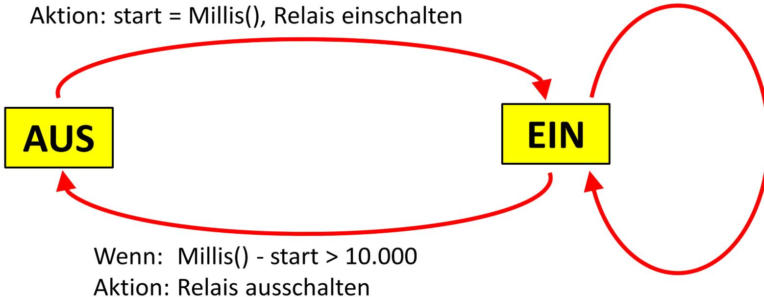
Zusatzaufgabe: Kurz bevor das Treppenlicht ausgeht, blinkt es 5 Sekunden lang zur „Warnung“. Auch während des Blinkens kann bei Bedarf „nachgedrückt“ werden.
