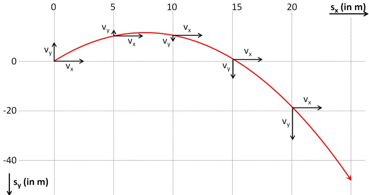
1. Zu Beginn ( $t = 0$ ) beträgt die  $x$ -Komponente der Geschwindigkeit  $v_x = 5$ m/s und die  $y$ -Komponente der Geschwindigkeit  $v_y = 15$ m/s. Die Kugel befindet sich zu Beginn an der Position  $s_x = s_y = 0$ .
