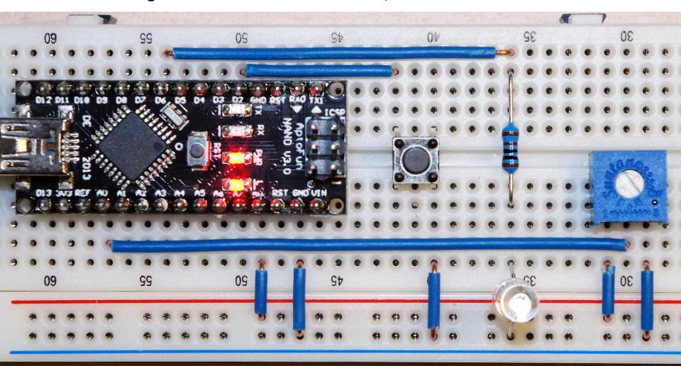
Die Leuchtdiode an PD6 und der Taster an PD2 können angeschlossen bleiben...
